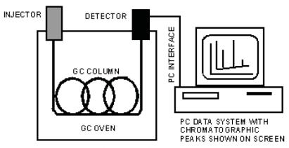
SCHEMATIC OF A GAS CHROMATOGRAPHY SYSTEM
